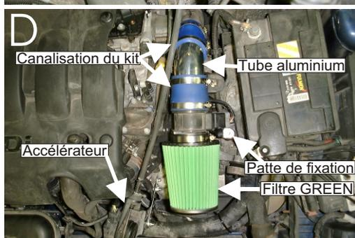
Positionner le filtre à air GREEN à l'aide de la patte de fixation et du silent bloc sur le support de la batterie.(schéma C et D)
