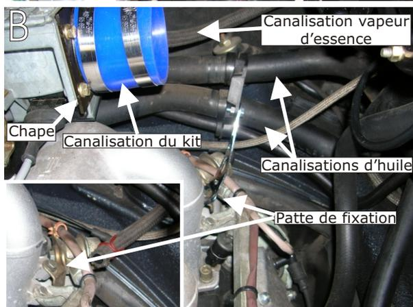
Fixer les canalisations d'huile à l'aide de la patte de fixation fournie sur le support du collecteur d'admission.(schéma B)
