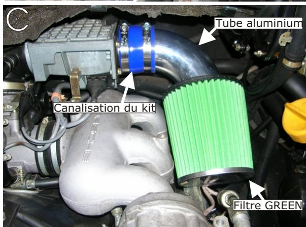
Emboîter le tube aluminium sur la canalisation du kit.(schéma C)
