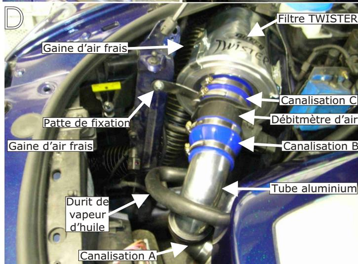
Emboîter le débitmètre d'air sur la canalisation B du kit.(schéma C et D)
