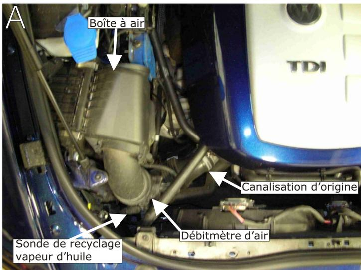
Déposer et supprimer la boîte à air d'origine complète.(schéma A)
